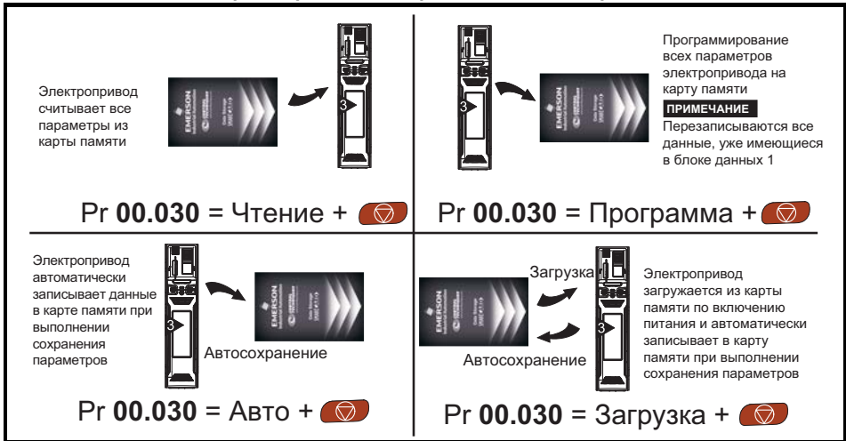
Рис. 8-2 Основные операции работы с энергонезависимой картой памяти
