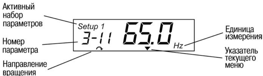
Рисунок 4.1 – ЛПО1 – Локальная панель оператора (с потенциометром) ПЧВ. Элементы индикации и управления
