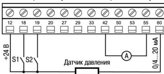
Рисунок 4.10 – Схема подключений конфигурации поддержания давления
