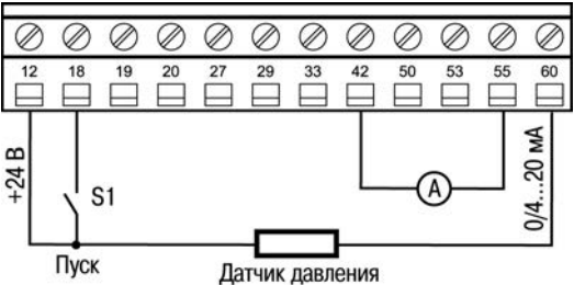
Рисунок 4.18 - Схема внешних подключений ПЧВ
