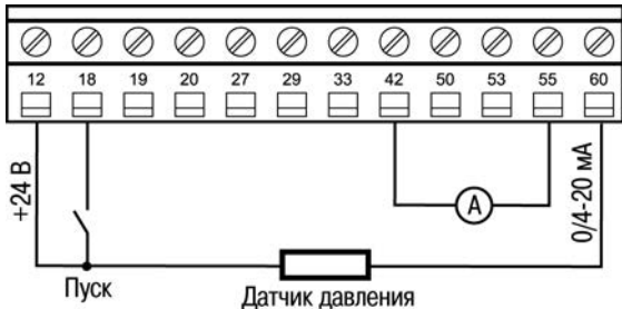
Рисунок 4.8 – Схема подключений для конфигурации «Поддержание заданного давления»
