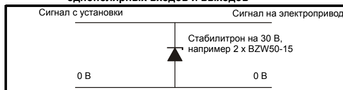
Рис. 4-15 Подавление выбросов для аналоговых и биполярных входов и выходов
