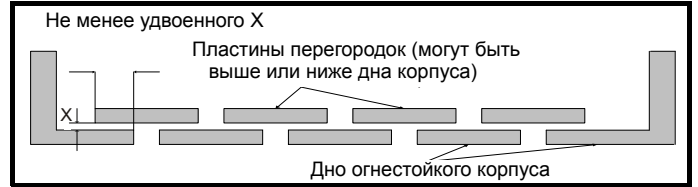
Рис. 3-2 Конструкция перегородок огнестойкого корпуса
