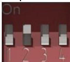
Рисунок 6.4 – DIP-переключатель. Джампер 2 в положении ON
