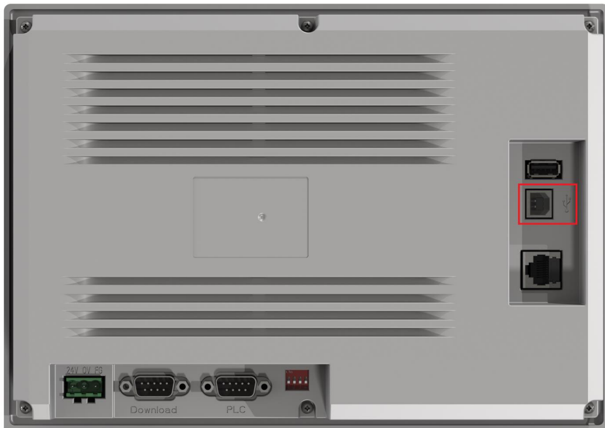
Рисунок 6.1 – Внешний вид задней крышки панели СП3хх-Р (порт USB В обведен красным)
