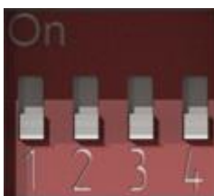
Рисунок 6.6 – DIP-переключатель. Джампер 2 в положении OFF
