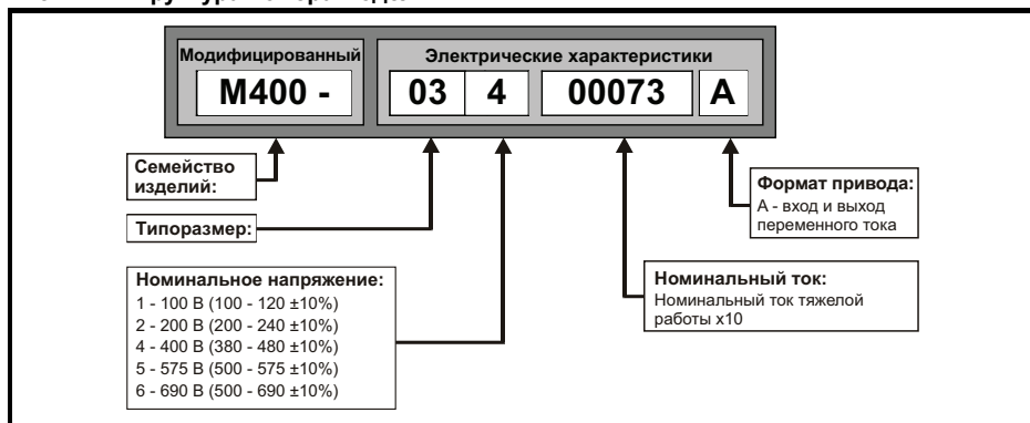
Рис. 1-1 Структура номера модели
